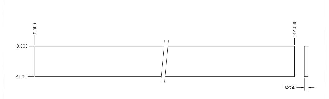
MANUFACTURED FROM ELECTROLYTIC TOUGH PITCH COPPER ALLOY 110.
